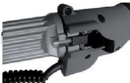
Abb.1-2: Einstellen des Befestigungshebels
