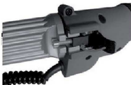
1-2. ábra: Állítsa be a rögzítő kart, biztosan rögzítse
