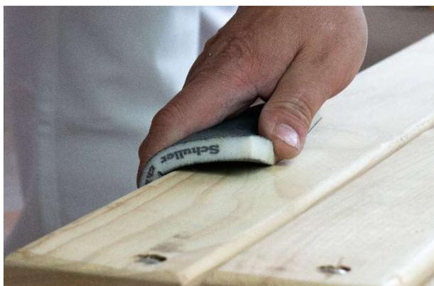
Das SOFTCUT FLEX Schleifkissen ist bestens für Trocken- und Nassschliffe geeignet. Durch die Flexibilität für die unterschiedlichsten Arten von Schleifungen verwendbar.
