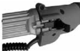
Fig. 1-2: Fixați-l cu blocul de fixare
