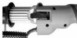
Fig. 1-3: Apăsați blocul pentru a fixa întreg ansamblul
