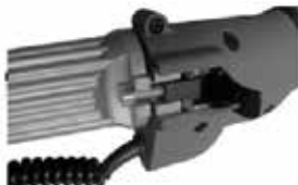
Abb.1-2: Einstellen des Befestigungshebels
