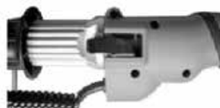
Immagine 1-3: premere sul manico per fissare
